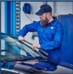
**1** Zierleisten, Dichtungen und Scheibenwischer nach Angaben des Fahrzeugherstellers entfernen. Die beschädigte Windschutzscheibe mit Hilfe eines Schneidedrahts oder eines Spezialmessers heraustrennen. Die defekte Glasscheibe mit Saughebern entfernen.
