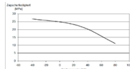
Zugscherfestigkeiten in Abhängigkeit der Prüftemperatur:
