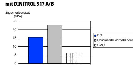
Zugscherfestigkeit nach 7 Tage Lagerung bei 23°C. Prüftemperatur 23°C
