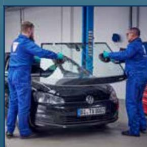
**10** Die neue Windschutzscheibe innerhalb der Offenzeit des Klebstoffs einsetzen und mit Hilfe des Klebebands positionieren. Anschließend erfolgt der Einbau der dazugehörigen Bauteile wie Zierleisten usw.
