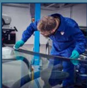
**4** Die zu verklebende Fläche (Keramikrand) der neuen Windschutzscheibe gründlich mit **DINITROL 582** reinigen, um hartnäckige Kontaminationen auf Glasflächen und Keramiksiebdruck zu entfernen. Nach dieser Reinigung 5 Minuten ablüften lassen.
