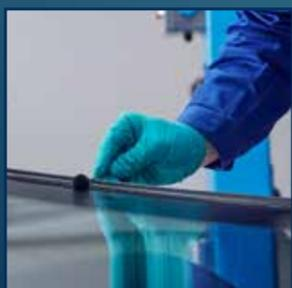
**5** Vor Gebrauch den One-Step-Primer **DINITROL 538 Plus** (Flasche) ca. 1 Minute schütteln, bis die Stahlkugel gut hörbar ist. Die Aluminiumtube enthält keine Stahlkugel, trotzdem muss auch diese Tube vor Gebrauch gut geschüttelt werden. Danach den Primer mit einem Wollwischer oder der Tube gleichmäßig in einer Lage auf die gereinigte Klebefläche auftragen.
