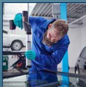
**9** Scheibenklebstoff als Dreiecks-Kleberaube entweder auf die Windschutzscheibe, auf den Karosseriefansch oder auf die frisch zurückgeschnittene Restraupe auftragen. **Hinweis: Die dreiecksförmige Düse muss entsprechend der Angaben des Fahrzeugherstellers zugeschnitten werden.**
