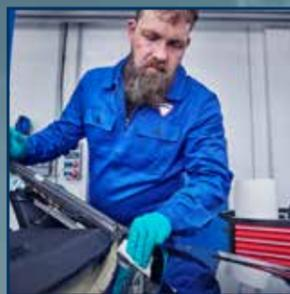
**6** Es ist wichtig, dass der Karosseriefansch gründlich gereinigt wird, zum Beispiel mit **DINITROL 582**, bevor die Restraupe auf dem Karosseriefansch zurückgeschnitten wird. Es muss darauf geachtet werden, dass auf der frisch zurückgeschnittenen Restraupe kein **DINITROL 582** oder Scheibenreiniger appliziert wird. Nach der Reinigung des Flansches kurz ablüften lassen.
