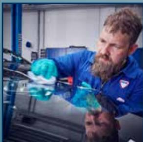
**3** Scheibe reinigen mit einem geprüften Scheibenreiniger, wie zum Beispiel **DINITROL 7250**, oder ein ähnlich bewährtes Scheibenreinigungsmittel ohne Ammoniak verwenden.
