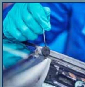
**8** Lackbeschädigungen am Flansch können mit dem One-Step-Primer **DINITROL 538 Plus** ausgebessert werden. Vor der Ausbesserung die Flasche ca. 1 Minute schütteln, bis die Stahlkugel gut hörbar ist bzw. die Primer-Tube (ohne Stahlkugel) ebenfalls ca. 1 Minute gut schütteln (siehe Bild 5).
