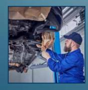
A Nach der gründlichen Reinigung und der anschließenden Trocknung muss sichergestellt werden, dass alle nicht zu behandelnden Teile, wie z. B. Bremsanlage und Teile der Klimaanlage, abgedeckt werden.
