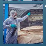
Nach durchgeführter Behandlung des Unterbodens werden abschließend noch die Hohlräume von Heckklappe und Motorhaube versiegelt. Bitte darauf achten, dass Motor und Kofferraum sorgfältig abdeckt werden.
