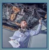
Nach der sachgerechten Reinigung und Vorbehandlung des Fahrzeuges ist es besonders wichtig, dass Sie das DINITROL Sprühdiagramm für das zu behandelnde Fahrzeug sorgfältig studieren. Nur so können Schäden an Elektrik, Airbags und anderen empfindlichen Teilen vermieden werden
