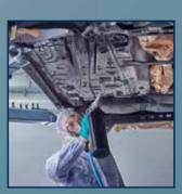
Als Nächstes kann der Unterboden mit dem zuvor verwendeten DINITROL Hohlraumschutzprodukt vorbehandelt werden. Allerdings muss zwingend darauf geachtet werden, dass der Unterboden nur leicht benebelt wird, um eine maximale Schichtstärke von 25 µm nicht zu überschreiten, da es sonst zu Haftungsproblemen bei der zweiten Schicht
