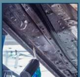
9 Nach 15 – 20 Minuten, jedoch nicht länger als 30 Minuten, sollte der Unterboden mit einem DINITRO Unterbodenschutzprodukt behandelt werden und eine Schichtstärke von 300 μm – 500 μm weder unternoch überschreiten.
