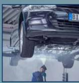
Es wird empfohlen, das Fahrzeug mit Entfettungsmitteln und einem Hochdruckreiniger gründlich zu reinigen, sodass jeglicher Schmutz und abblätternde Korrosion entfernt wird.
