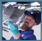
Im ersten Schritt sollten alle Kunststoffteile am Unterboden, an Radschalen und Türverkleidungen entfernt werden.
